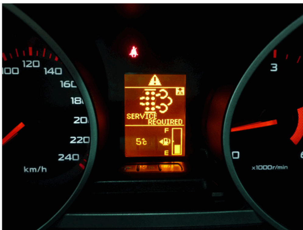
Фото 2 – "Требуется обслуживание системы выхлопа"
