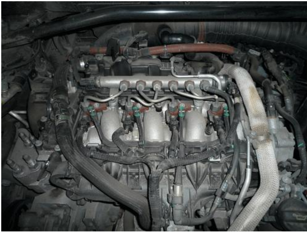
Фото 3 – дизель Peugeot 4HN без декоративной крышки
