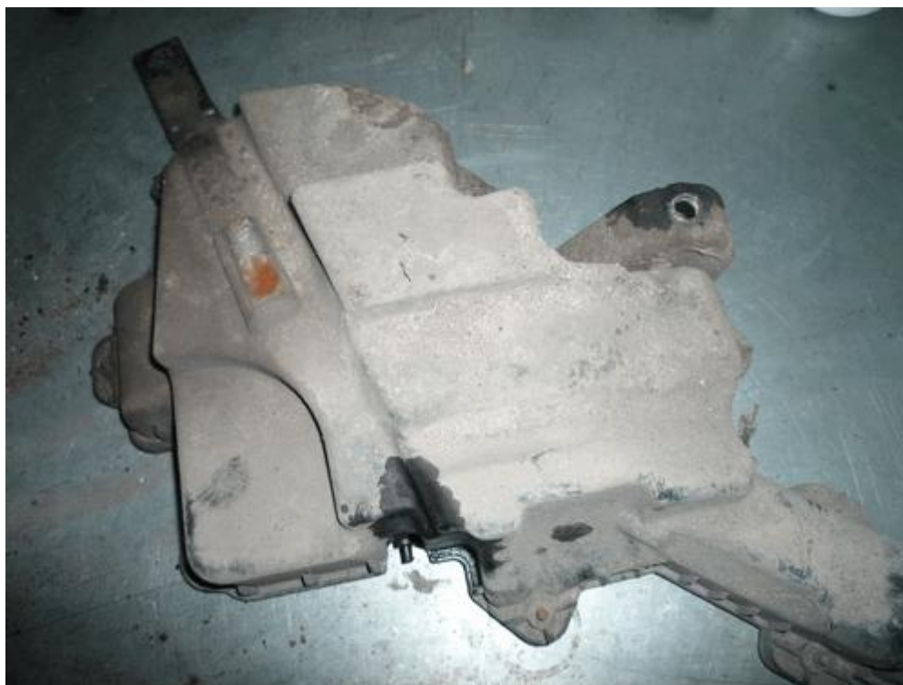
Фото 6 - демонтированный бачок для аддитива
