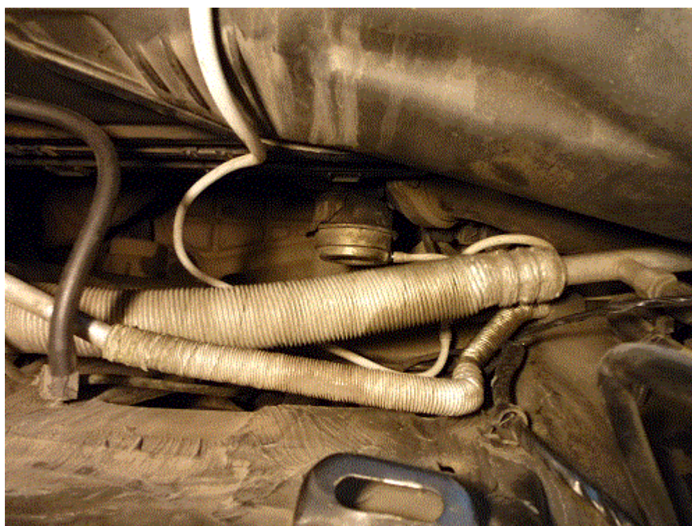
Фото 3 - подключение к вакуумному приводу Waste Gate
