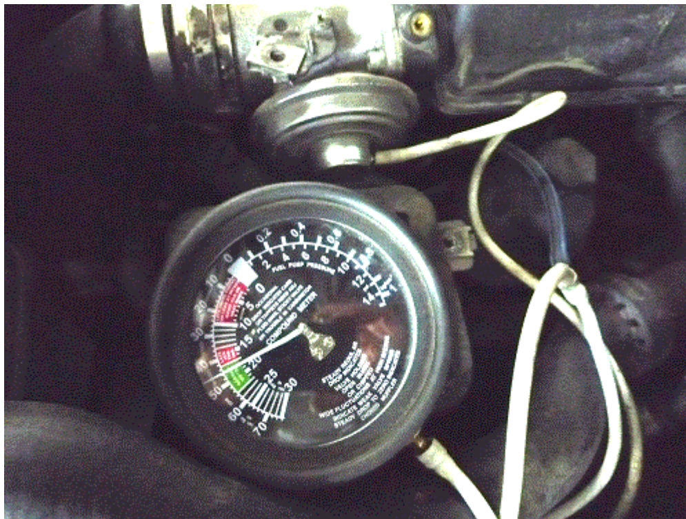
Фото 7 - разрежение на клапане EGR
