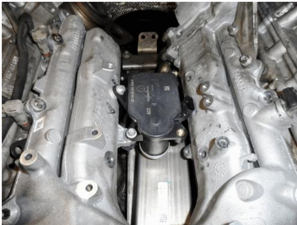
Фото 9 - новые коллекторы и новый сервопривод
