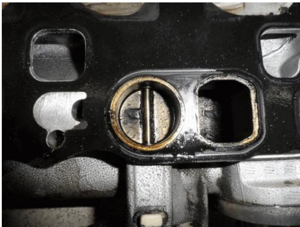
Фото 6 - заслонки заклинило в закрытом положении
