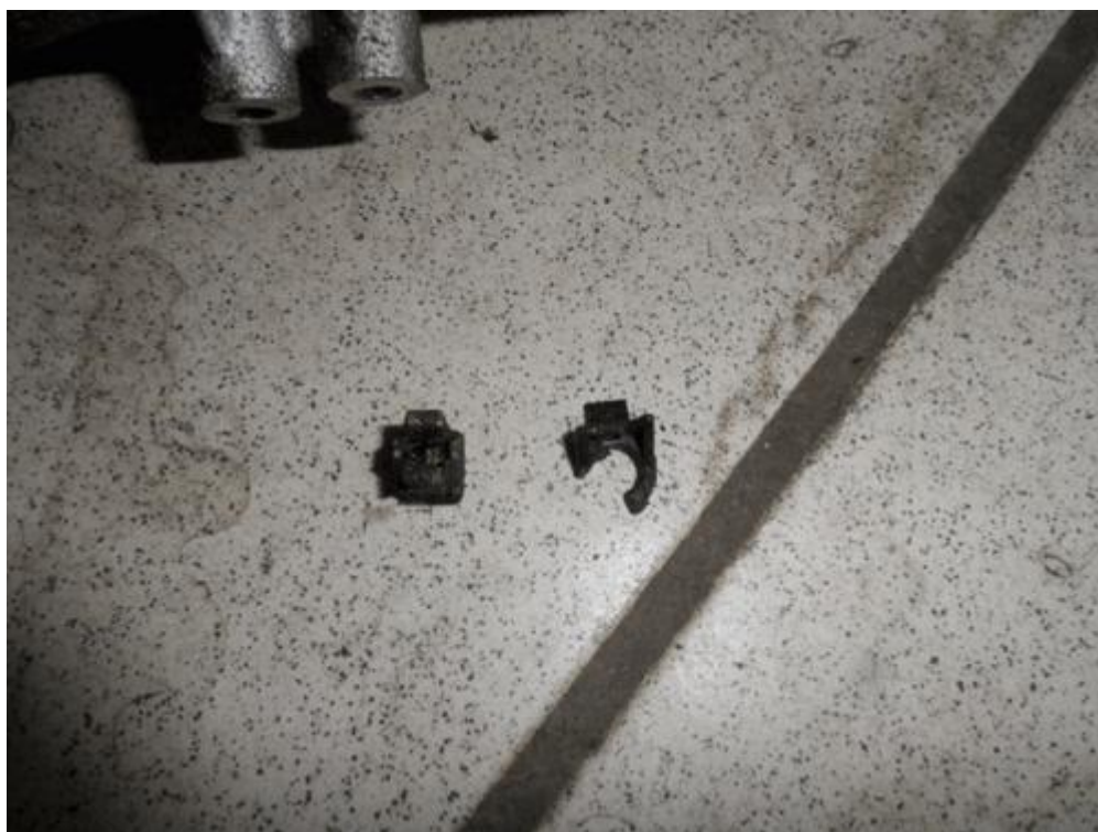
Фото 7 и 8 - пластиковые детали рассыпались
