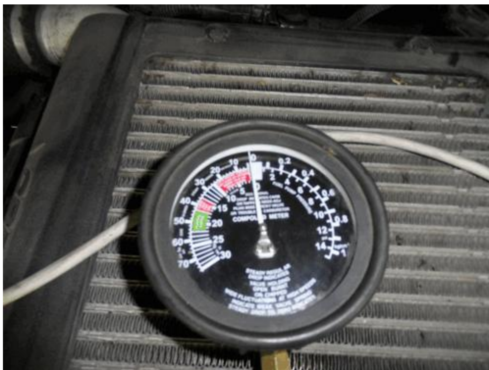
Фото 3 - поначалу разрежение почти равно нулю
