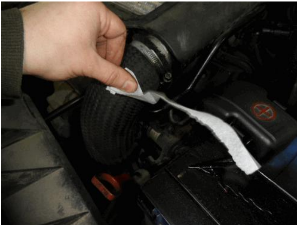
Фото 8: Из впускного патрубка "сифонит" воздух
