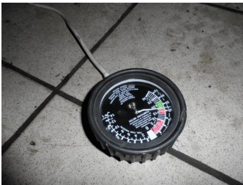
Фото 3 - значение вакуума на режиме х.х.
