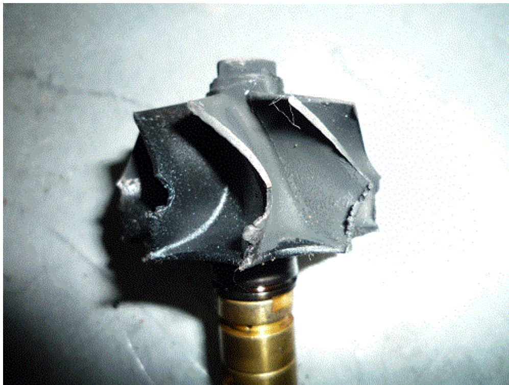
Фото 5 - турбинному колесу досталось по-полной
