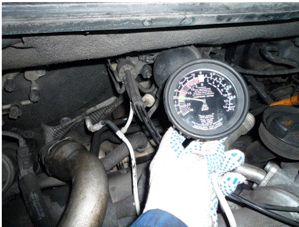
Фото 2 - разрежение на приводе в норме
