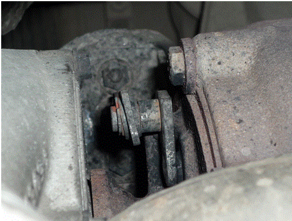
Фото 3 - направляющий аппарат заклинен в открытом положении
